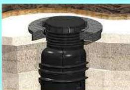
Para la colocación de la tapa de registro, en el caso de que el pozo esté instalado en zonas sometidas a cargas pesadas, realizar un anillo de hormigón alrededor de la boca del mismo, que no le transmita ningún tipo de cargas y que soporte la tapa de registro.
